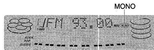
Pour rétablir la réception stéréophonique, appuyez sur **MONO TUNER** de la télécommande tout en maintenant **SHIFT** enfoncée de telle façon que "MONO" disparaisse.
